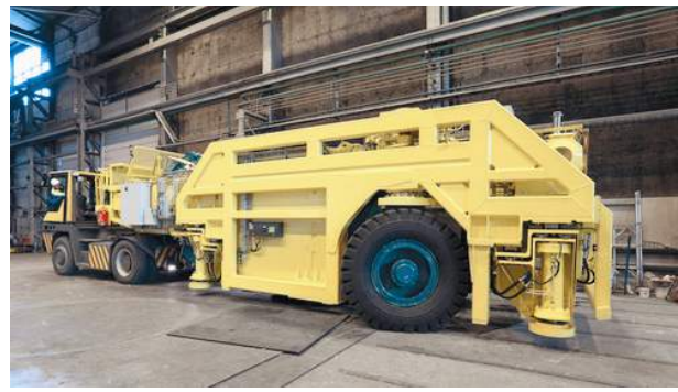
Рис. 10.8. Прототип устройства по доставке и установке канистр с РАО
