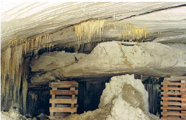
Рис. 5.9. Ассе II: рыхлые горные породы и точки конденсации в отсеке 5 на глубине 700 м (1993 год)
