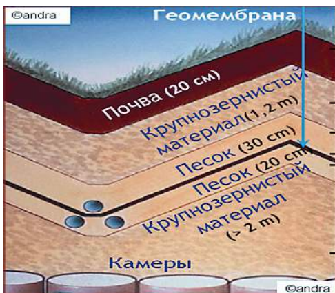
Рис. 11.8. Многослойное покрытие пункта захоронения Мани
