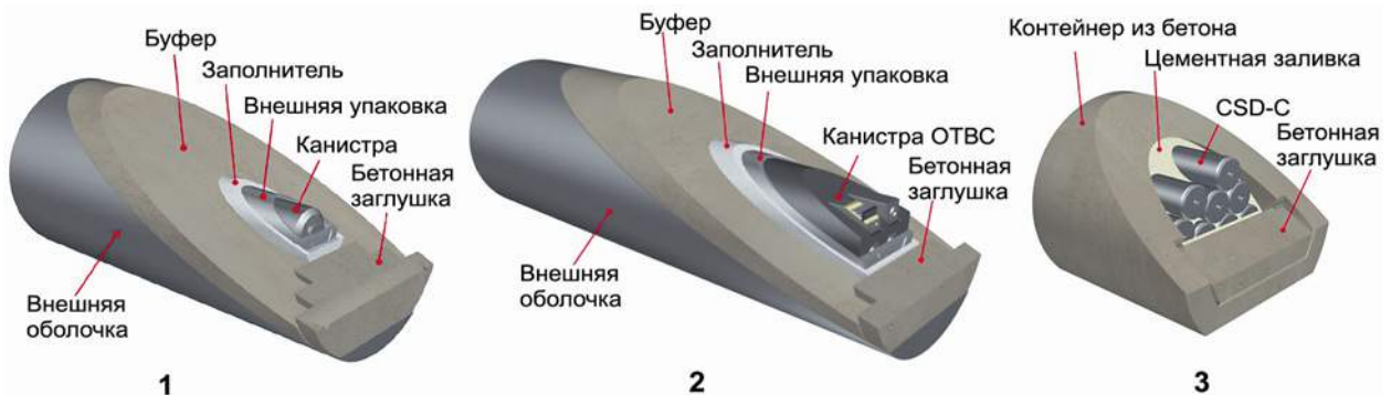
Рис. 2.8. Внешний вид «суперконтейнеров» для захоронения ОЯТ и остеклованных ВАО (1, 2), и монолита для захоронения отходов категории В (3)
