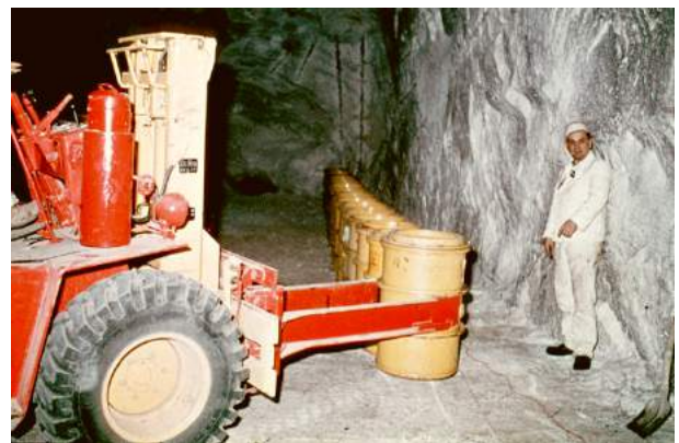
Рис. 5.8. Работы по захоронению РАО (Ассе, 1967 год)
