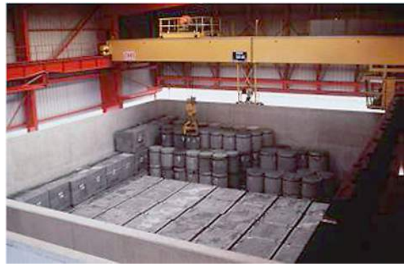
Рис. 11.12. Размещение контейнеров и канистр с РАО с использованием крана (слева) и заливка слоя цемента поверх металлических канистр с РАО (справа)
