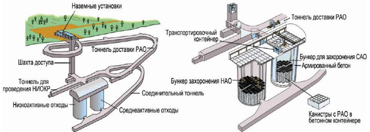
Рис. 10.4. Пункт захоронения НАО и CAO в Олкилуото (глубина 60–95 м)
